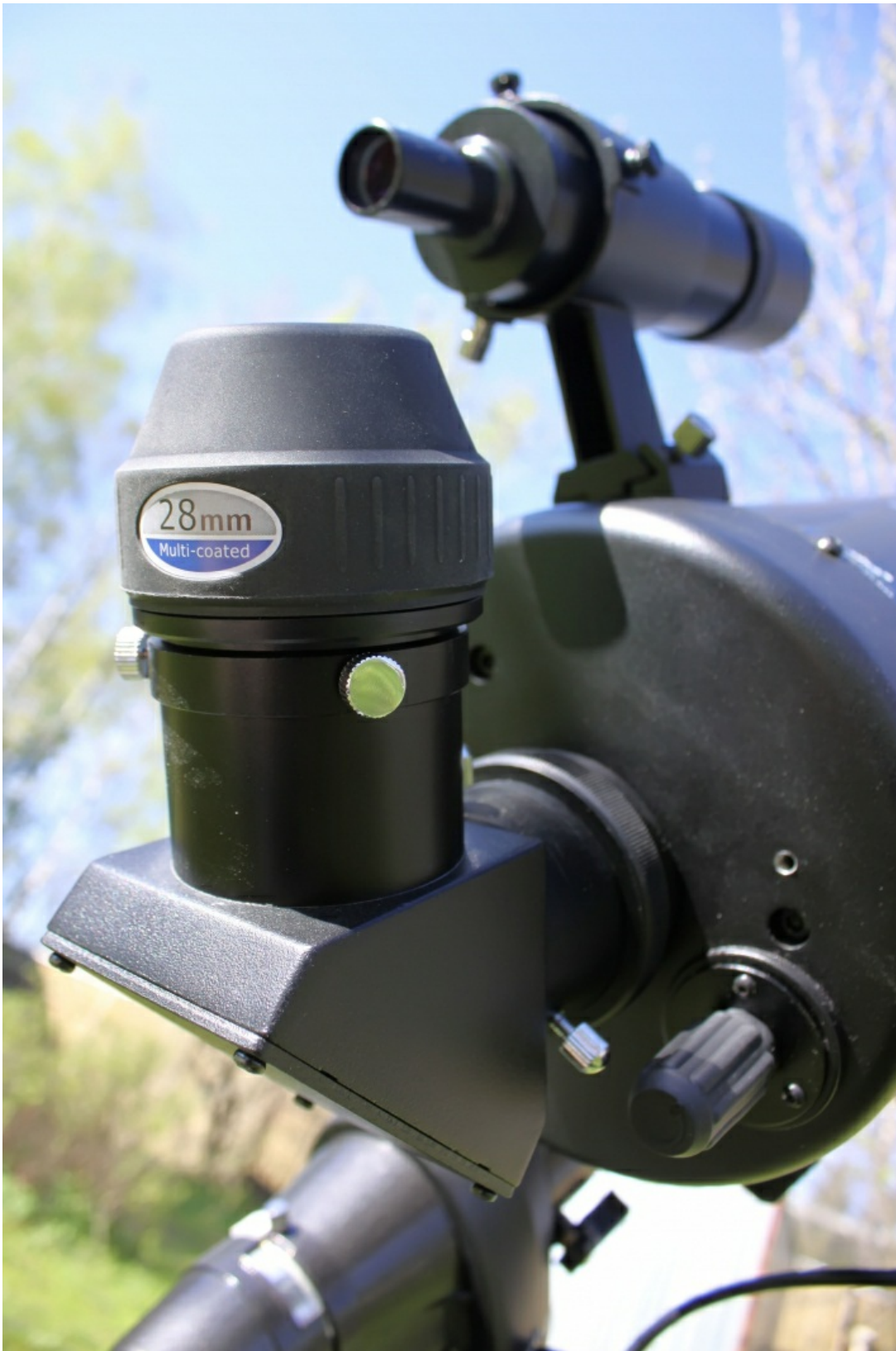
Телескоп комплектуется двухдюймовым окуляром с фокусным расстоянием 28мм, снабженным резиновым выдвигающимся наглазником.
