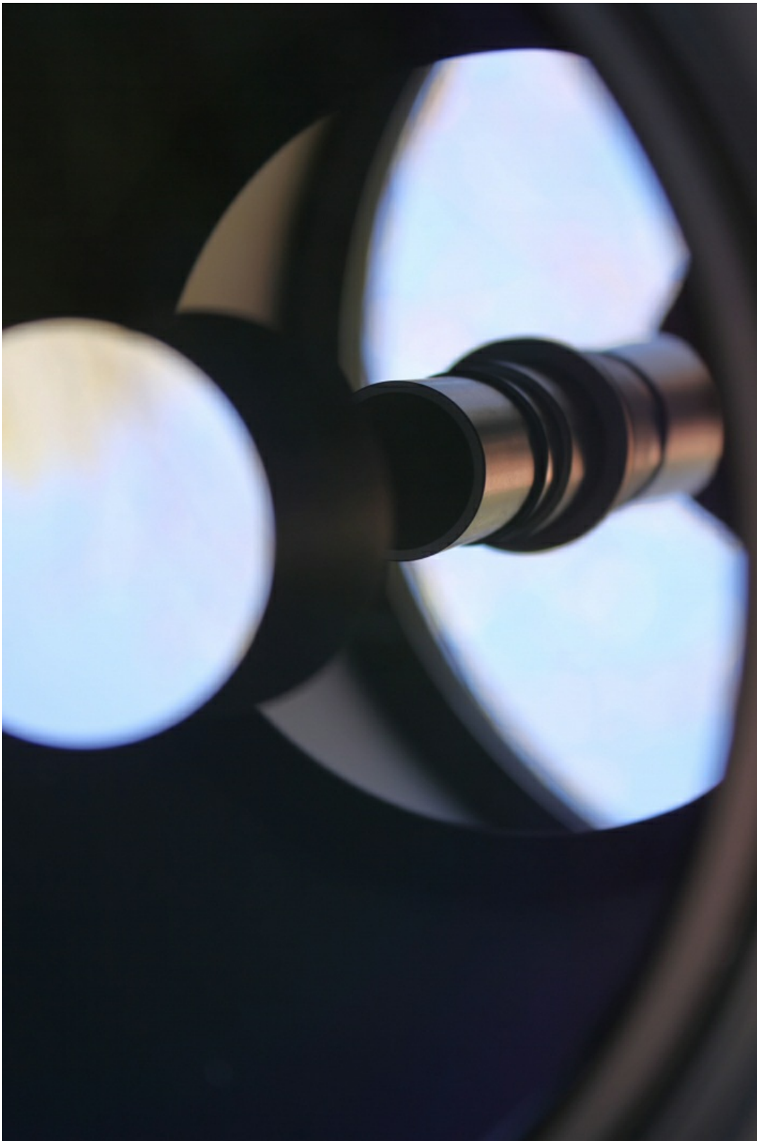
Через диагональное зеркало мы наблюдаем небольшую чёрную точку - это экранирование вторичным зеркалом в системе.
