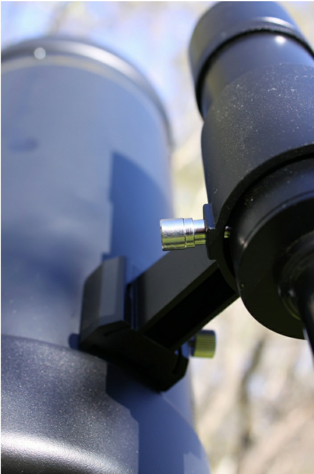
Оптика искателя просветлена, а на внутренней поверхности оправы имеется зачерненная резьба для борьбы с переотражениями.
