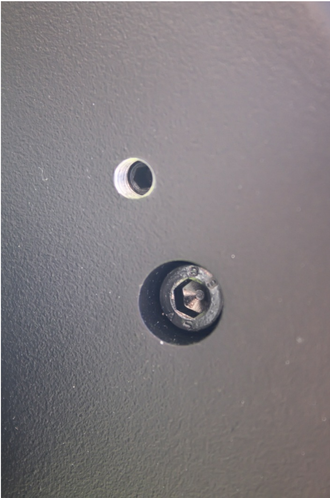
На корпусе диагонального зеркала расположены винты фиксации окуляра.
