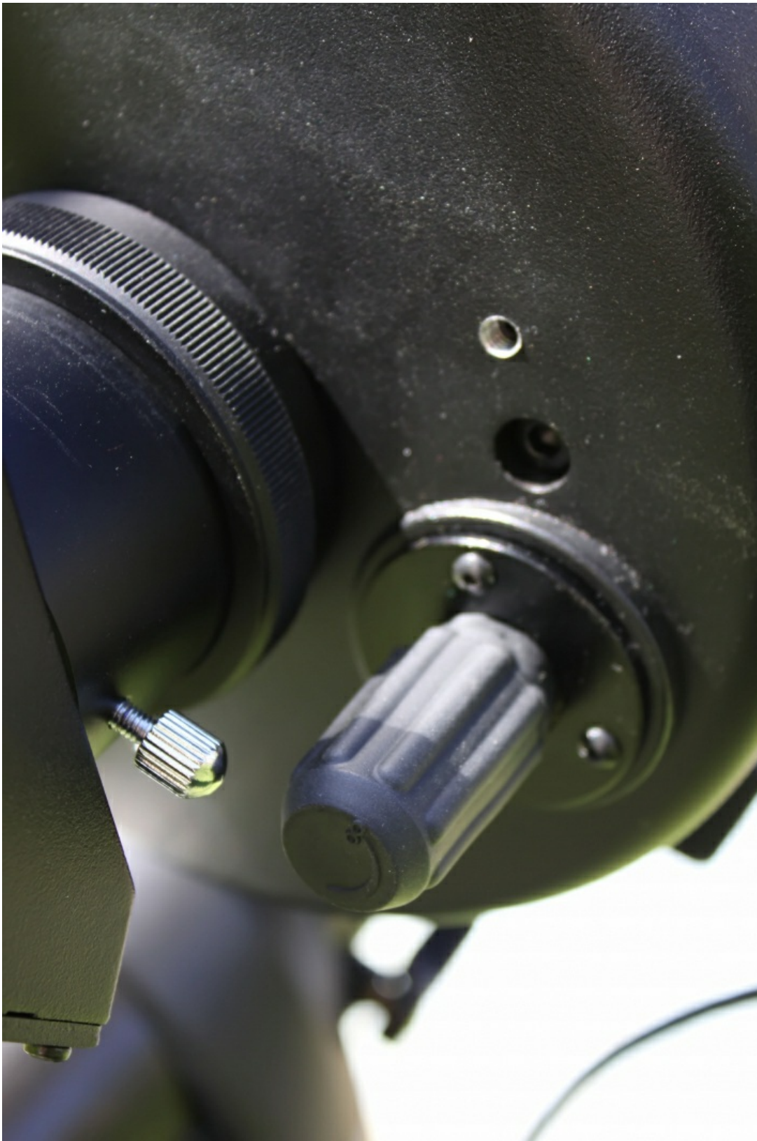
Двухдвоймовое диагональное зеркало крепится к корпусу трубы при помощи переходника с кольцом и прижимается винтами на корпусе переходника.
