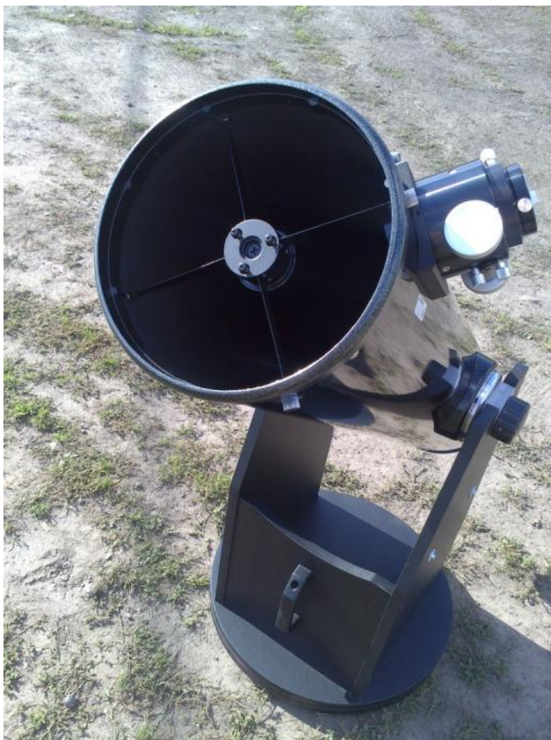
Диагональное зеркало крепится в оправе подвешенной на пауке из четырёх растяжек (1.2мм).
