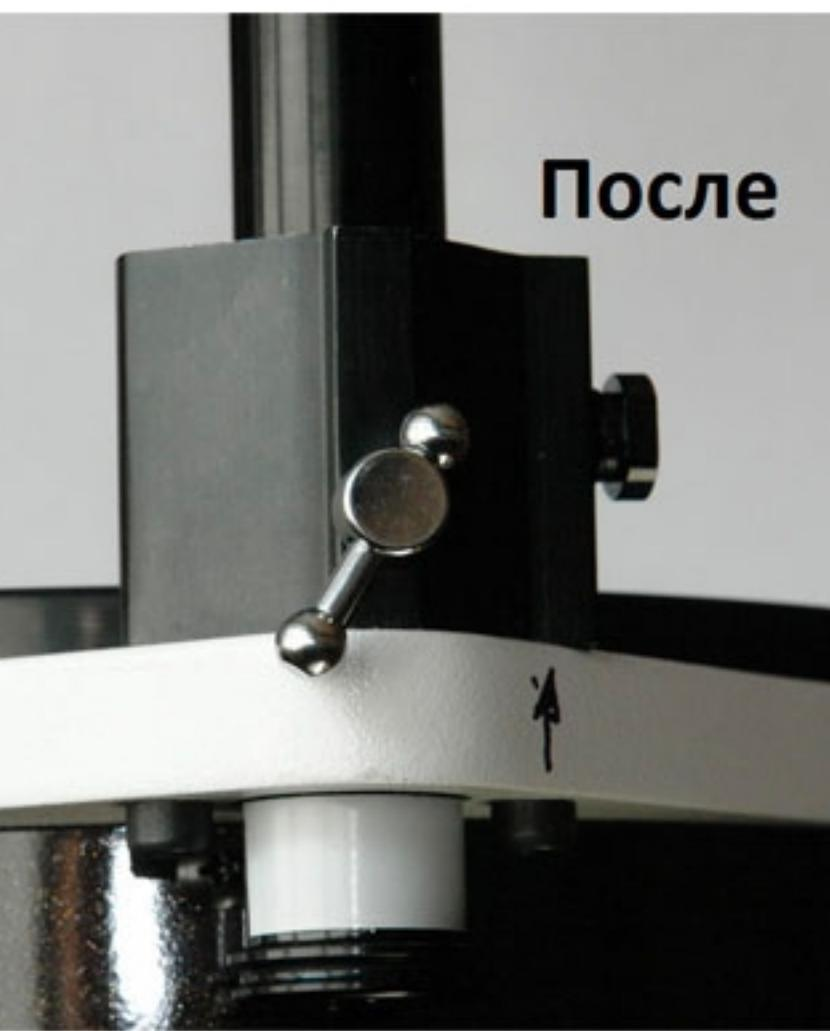
А в каждой штанге просверлил по одному дополнительному отверстию, куда входят защёлкивающие шарики:
