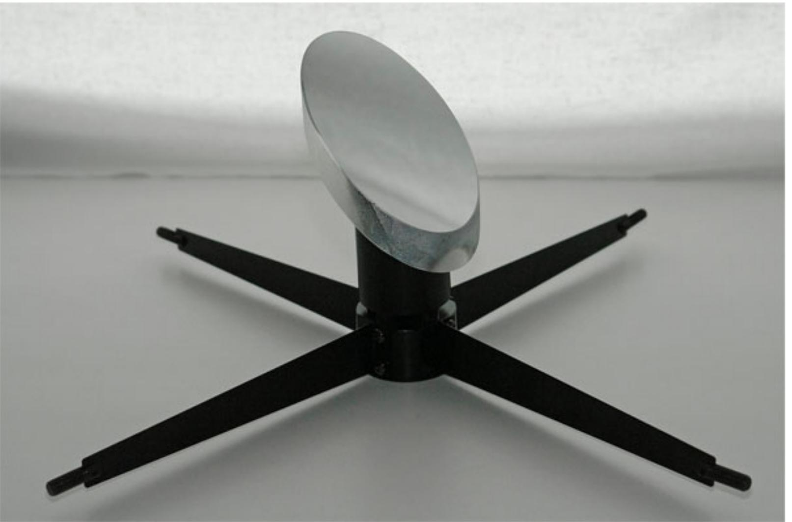
А вот с вторичным зеркалом есть проблемы. Его ширина составляет 58 мм и недостаточна для телескопа такой апертуры. Когда первый раз начал юстировать телескоп, то обнаружил что из фокуса телескопа во вторичном зеркале не видны лапки крепления главного зеркала. А они должны быть видны:
