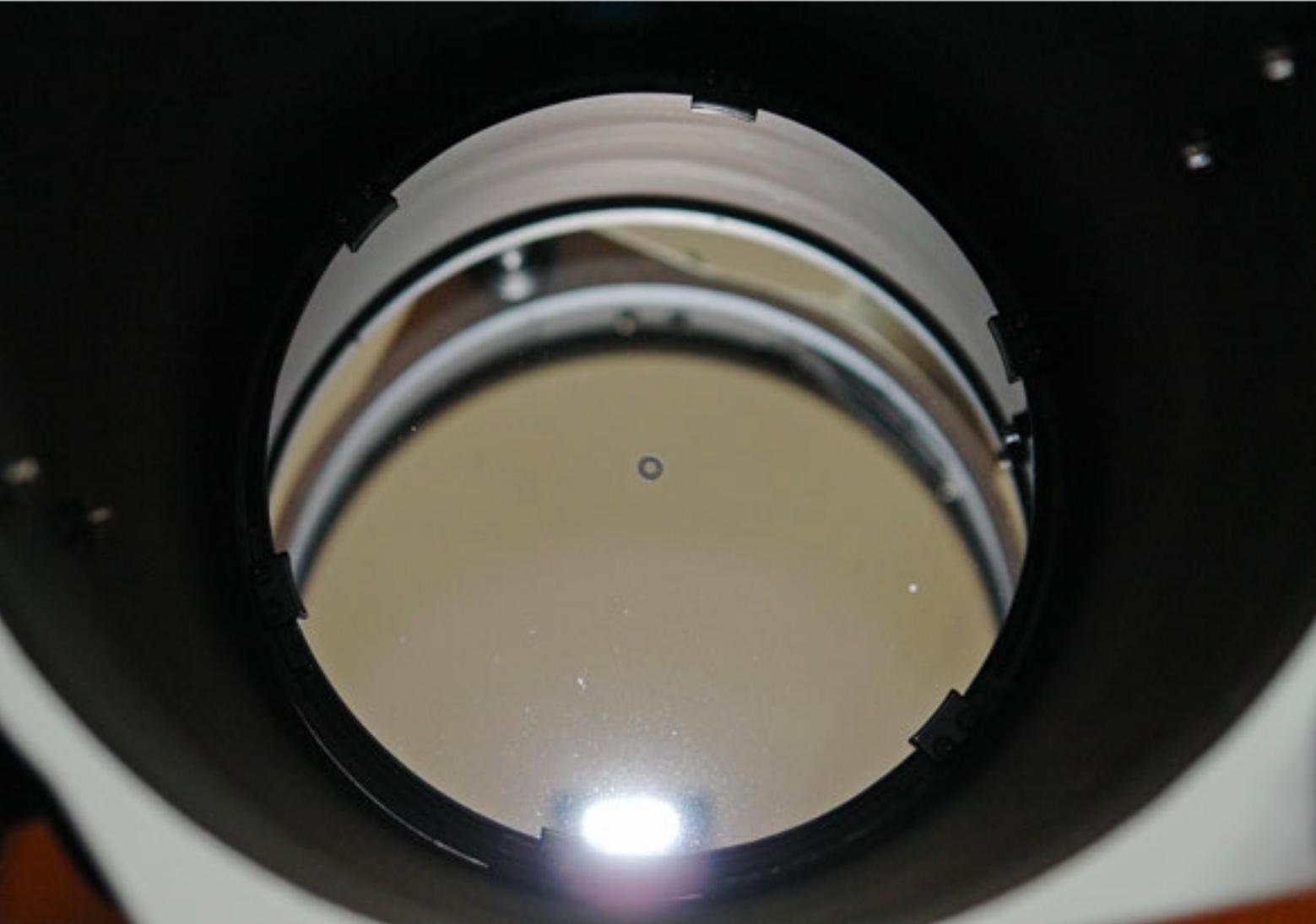
На задней части трубы видно тыльную сторону главного зеркала и шесть винтов: три юстировочных и три стопорных. Ближе к центру в креплении зеркала имеются четыре резьбовых отверстия для установки вентилятора:
