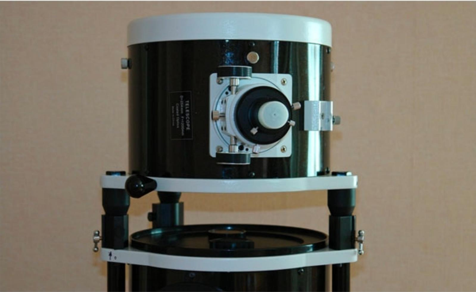
Ещё пришлось помудрить с переходными кольцами для окуляров, чтобы трубу фокусировочного узла не вдвигать на те же 27 мм вглубь телескопа (иначе она будет загораживать часть света поступающего в телескоп). Зато теперь телескоп дышит полной грудью – 254 мм! Особых изменений при наблюдениях от этой доработки я не заметил, но зато теперь не терзаюсь мыслью что зеркало работает не полностью.
