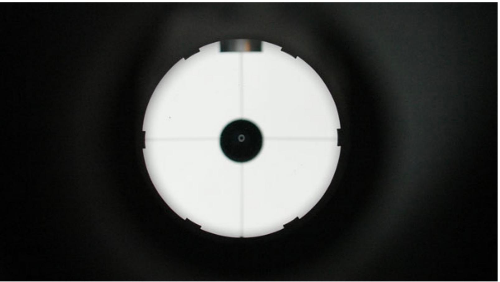
Если их не видно, то значит часть апертуры телескопа срезается вторичным зеркалом, и эффективный диаметр зеркала становится около 239 мм вместо положенных 254 мм. Для решения этой проблемы надо или отодвигать вторичное зеркало вместе с фокусировочным узлом дальше от главного зеркала, или увеличивать размер вторичного зеркала.
