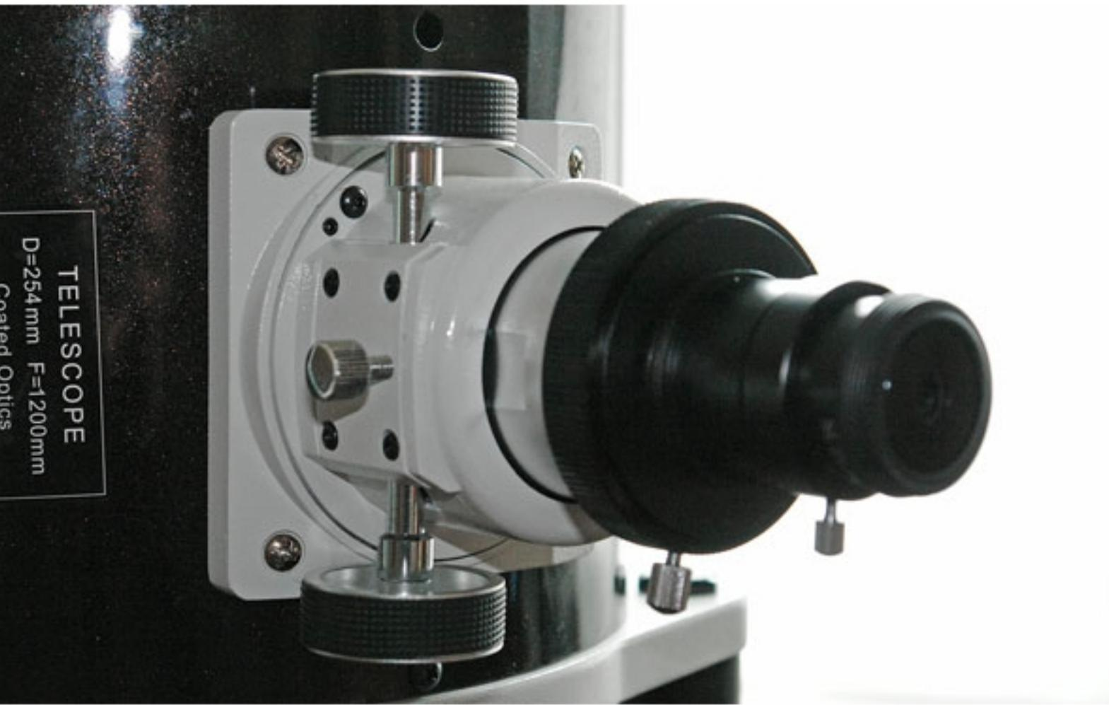
Фокусёр телескопа обладает довольно большим ходом и возможностью фиксации положения, в трубку фокусёра устанавливается адаптер для окуляров 1,25" или 2". Переходник на 1,25" имеет разборную конструкцию – открутив втулку под посадку окуляра, получается кольцо с резьбой M42x0,75, которая подходит для установки ПЗС-камеры или фотоаппарата.
