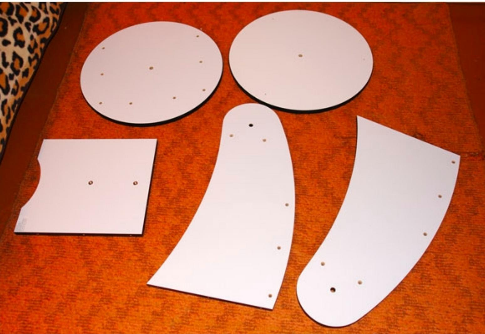
Монтировка не спеша собирается за час. Все плиты и фурнитура подходят друг к другу. Инструкция по сборке прилагается. Монтировка жёсткая, ничего не гнётся, не люфтит. Верхняя вращающаяся часть опирается на тефлоновую шайбу, которая изображает из себя подшипник. Усилие для
