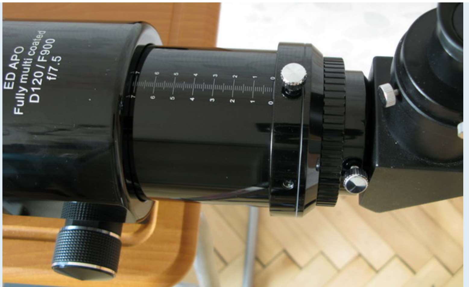
Ключ фиксации фокусировки и винт регулирующий усилие хода фокусировщика
