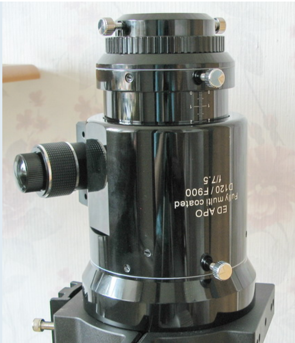
Шкала фокусировщика по верхней части окулярной трубки
