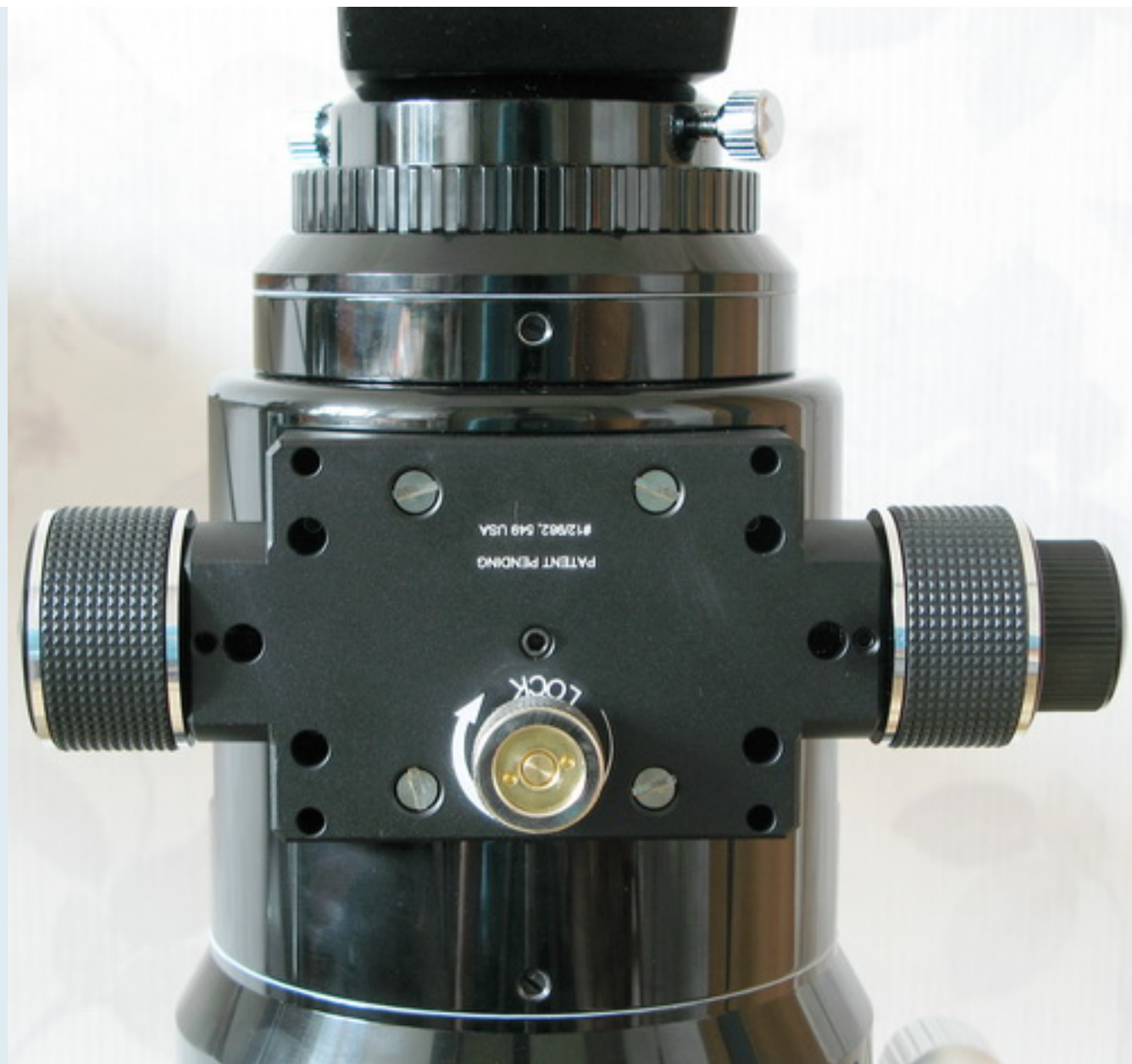
2.7" трубка для присоединения окулярных устройств с широким полем
