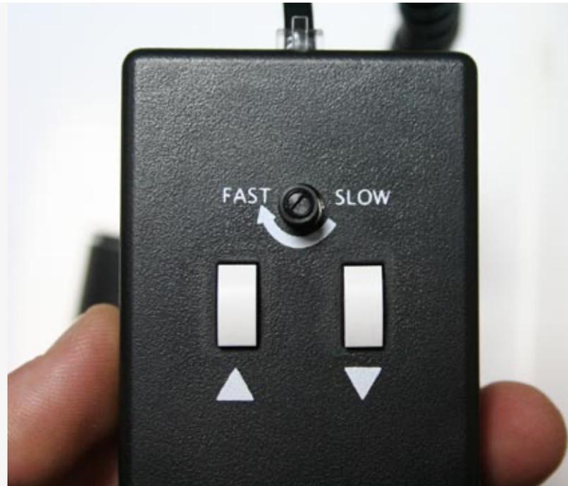
Соединяется с редуктором витым проводом. Питается электрофокусёр от одной батареи типа «Крона», 9 вольт.
