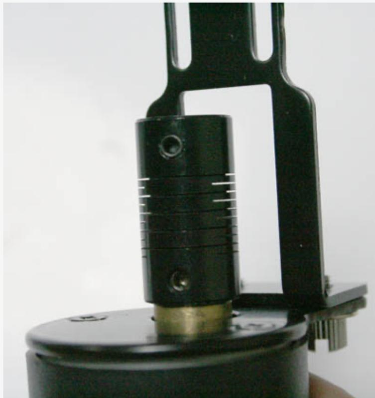
имеет поперечные пропилы для компенсации несоосности. Пульт имеет две кнопки и регулировку скорости вращения (см. фото).
